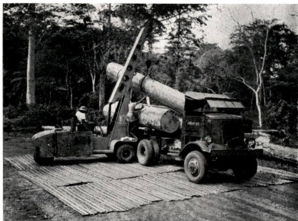
Chargement d'un camion grumier au moyen d'une grue Hyster
