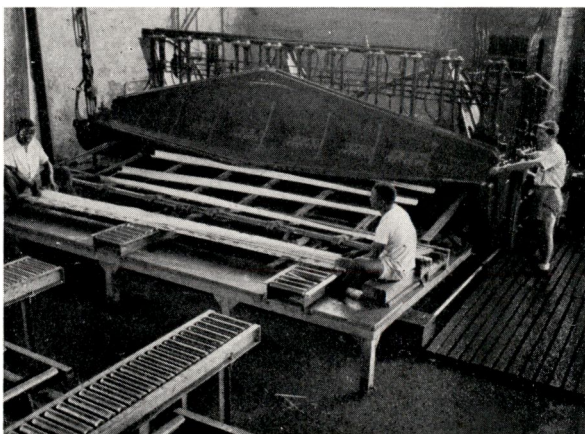
Usine de la Compagnie des placages et contreplacages du Congo, trancheuse verticale (Lemba)
