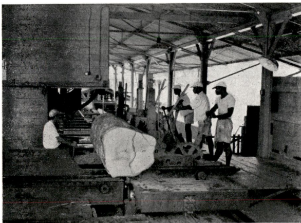
Scierie de l'Agrifor à Lemba, scie à ruban de 1,80 m
