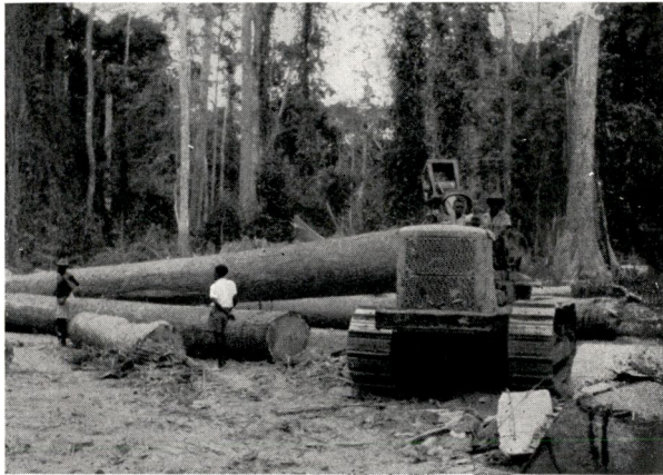
Débardage par tracteur à chenilles avec arche Hyster
