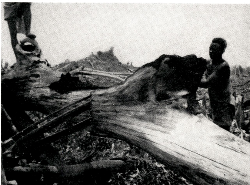
Scie 350 en action sur la base d'un fût qui dépasse 1,25 m de diamètre Lukumete (H.C.B.)
