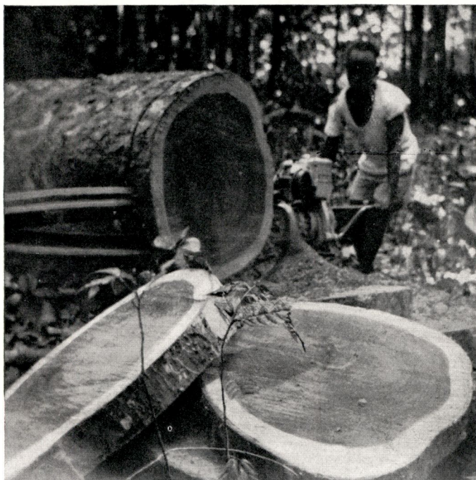
Exemple de tronçonnage d'un Gilbertiodendron dewevrei, du diamètre de 1,20 m, vitesse de sciage 45 secondes
