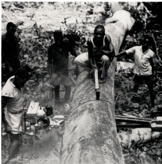
Pour éviter le coinçage, la grume est calée par le dessous à l'aide d'une branche
