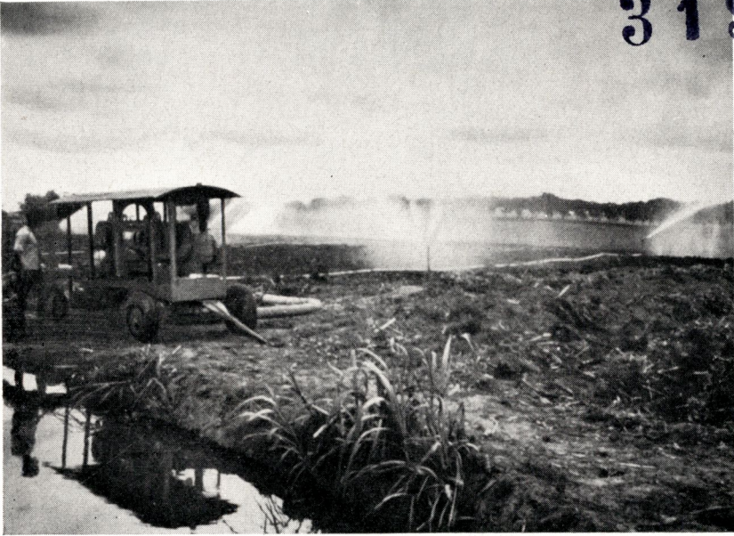
Photo 13 — Groupe de pompage avec moteur Diesel pour l'irrigation d'une jeune plantation de cannes à sucre (Perrot)
