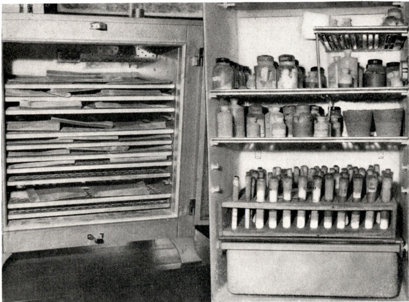
Fig. 3 — Disposition des enveloppes de pollen dans l'étuve de séchage ; conservation des pollens en tubes dans un frigo
