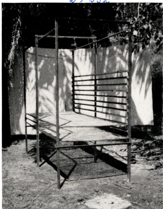
Fig. 5 — Fumoir de type B: A et B — Étagère métallique en cours de montage
