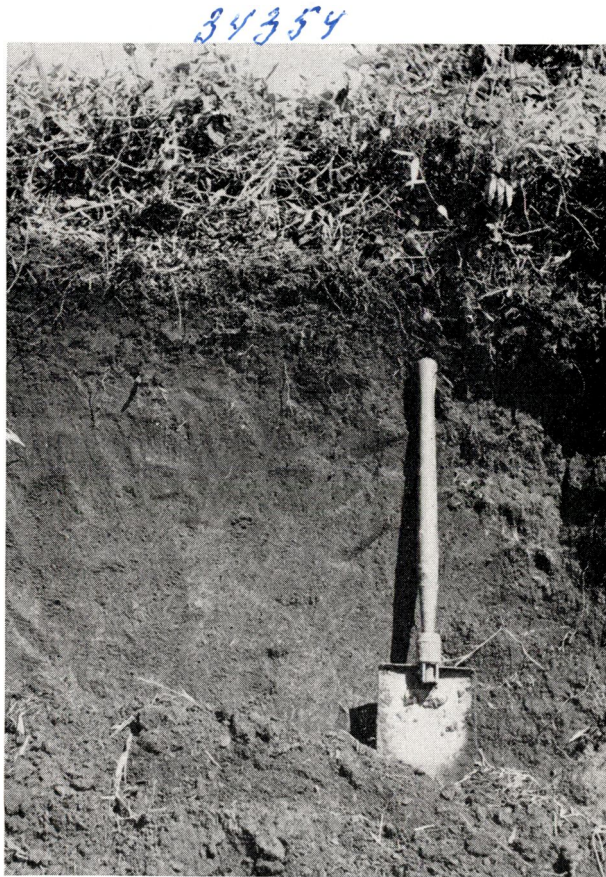
Fig. 2 — Profil du sol sous bambous et couverture de luizi ( Panicum spp.); horizon épais noirâtre de matières organiques (30 cm), sous-sol argileux compact
