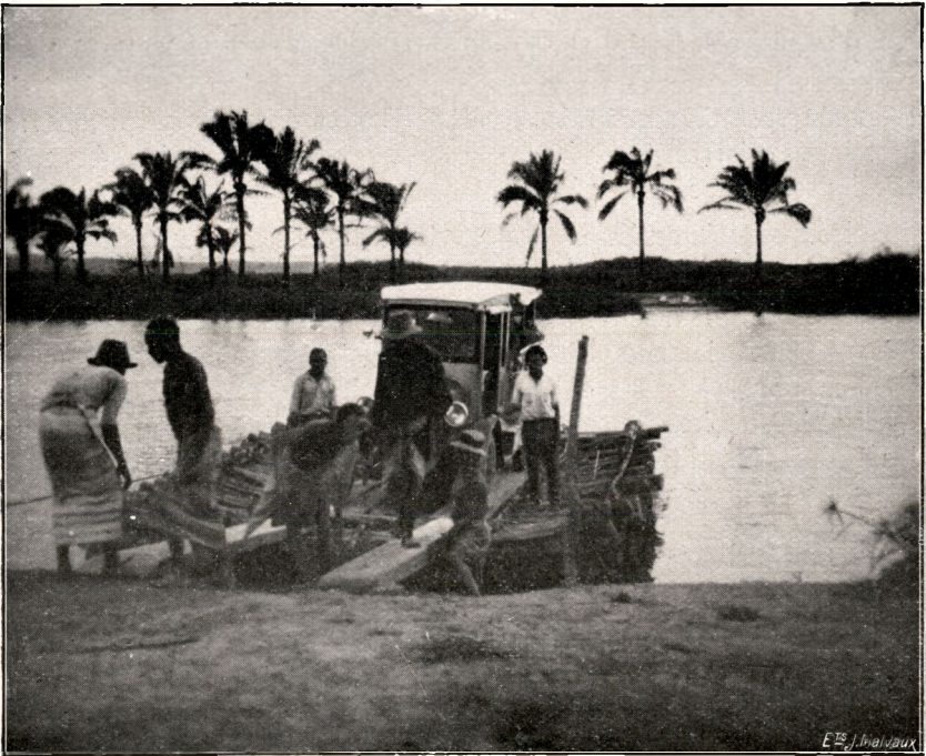
Fig. 27. — Passage de la rivière Cuvo sur radeau de fascines. (Photo Janssens.)
