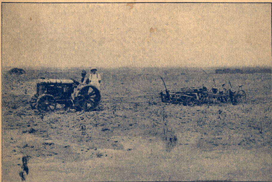
Tracteur Fordson effectuant simultanément le hersage et le semis (Lomami, Congo Belge).
