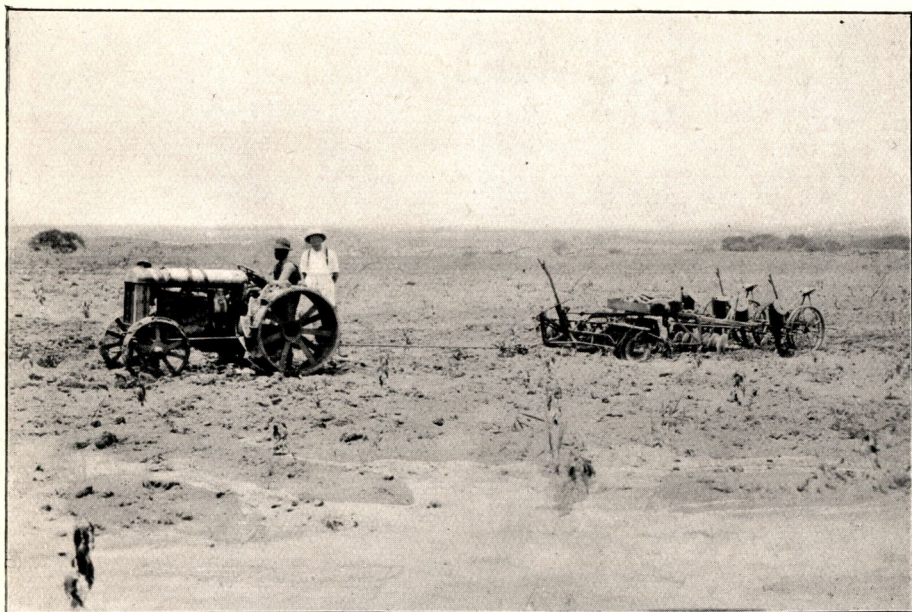
Fig. 72. — Tracteur Fordson effectuant simultanément le hersage et le semis.
