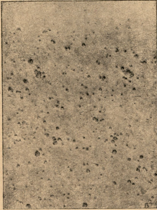
MICRO-PHOTOGRAPHIE DE LATEX D'HÉVÉA AVEC LES PARTICULES DE CAOUTCHOUC.
