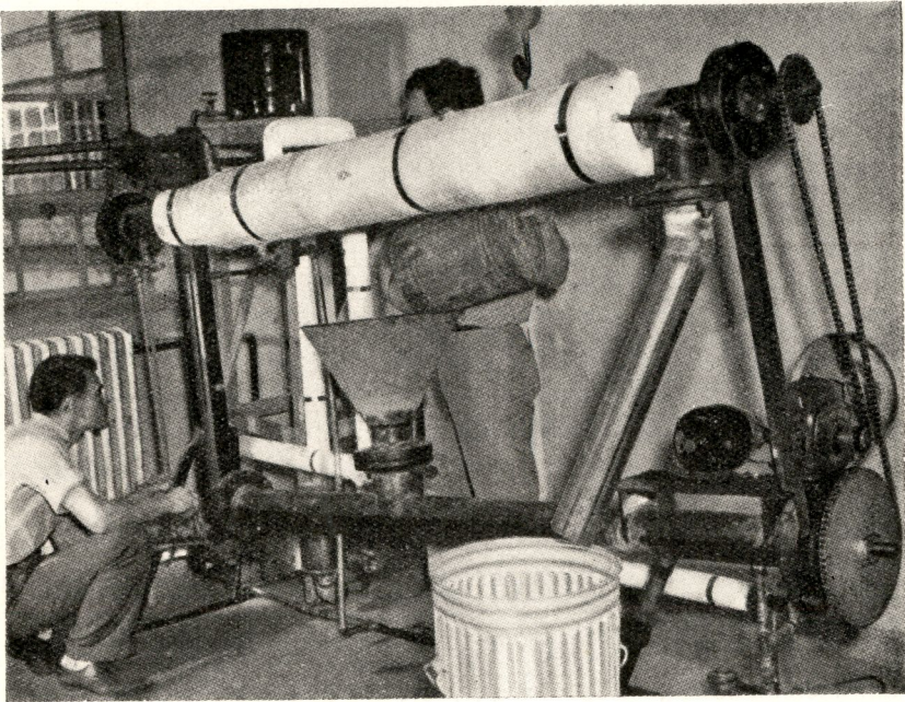
FIG. 2. — Installation de laboratoire pour l'étude de l'extraction continue aux solvants, au « Texas A. & M. College ».
